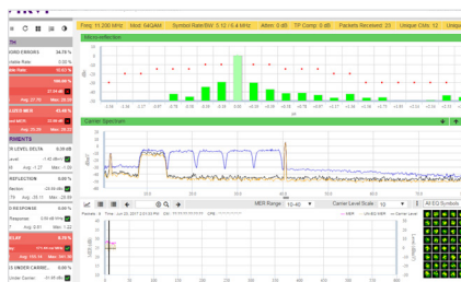
ライブ MACTrak のディスプレイに マイクロリフレクションを表示
