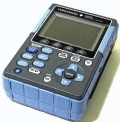
測定ライン 単相2線,単相3線,三相3線,三相4線, 測定項目 電圧,電流,周波数,有効電力,演算項目 皮相電力,無効電力,有効電力 量,皮相電力 量,無効電力 量,力率,中性電流,デマンド,高調波,電源品質, 電圧RMSレンジ 600/100V,電流RMSレンジ クランプ型番による, 周波数表示範囲40~70Hz,電源AC100~240V&単三乾電池×6 2電源式, 2GB SDカード付き ※クランプは別途必要です 仕様記号-B1-M -B1:Bluetooth機能有,-M:ACコード(国内用)
