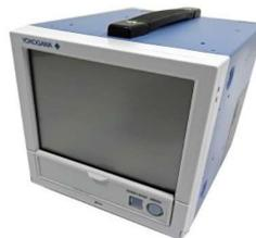
スマートダック ペーパーレスコーダー仕様 GP10-111M/AS/UH タッチパネル方式操作:4線抵抗式2点タッチ検出.最大モジュール数3, 最大チャンネル数30,内部メモリ500MB,外部記憶メディアSDカード32GBまで, OP:-1(標準),J(日本語),1(100V AC),M(電安法PSEケーブル),/AS(拡張セキュリティ機能Part11対応),/UH(USBインタフェース(ホスト2ポート)) ※パブリケーションライセンスは必要時、別途お客様で準備いただく必要がございます
