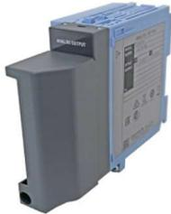
GX90YA-04-C1N-3N GX90YA:アナログ出力モジュール -04:4チャンネル -C1:電流出力(チャンネル間絶縁) 出力種類:伝送出力、マニュアル出力 レンジ:4-20mAまたは0-20mA 出力更新周期:最速100ms 負荷抵抗:600Ω以下 分解能:0.002% N:常にN -3:ねじ端子(M3) N:一般モデル
